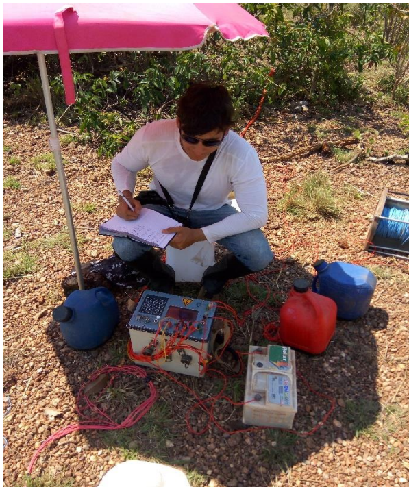
Figura 2– Foto evidencia a aquisição de dados geoeletricos na área.
