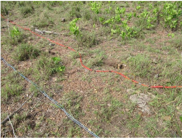
Figura 3 – Linha de aquisição do método da polarização induzida realizada na área.
