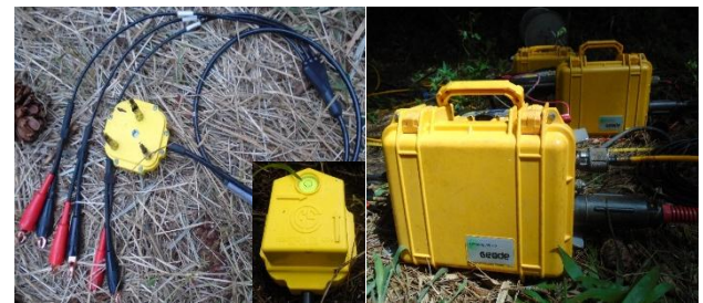
Figura 4 - Geofone de três componentes de 10 Hz (esquerda), sismógrafo Geode de Geometrics de 24 canais (direita).
