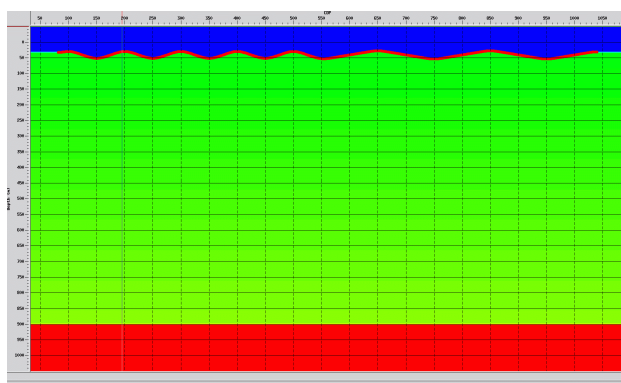
Figura 4: Exemplo de Campo de Velocidades (Modelo 3) com o horizonte da base da ZBV plotado no mesmo.
