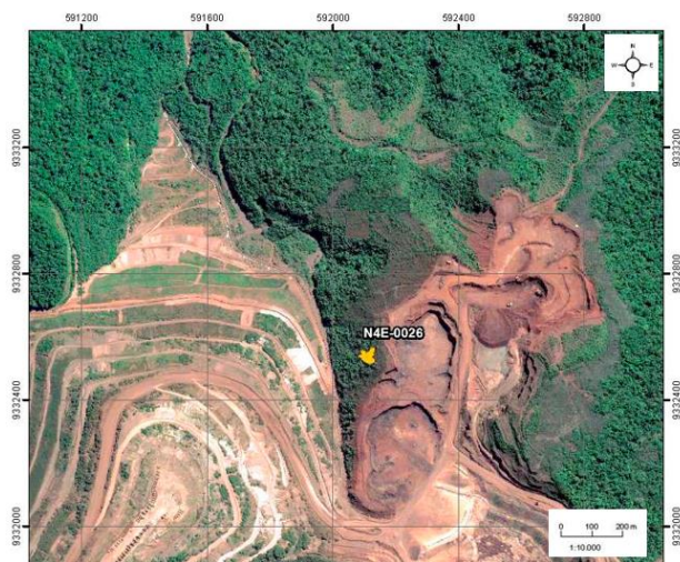
Figura 2 - Área de estudo na Mina N4E. Notar em amarelo a planta da cavidade N4E-0026 projetada na superfície.
