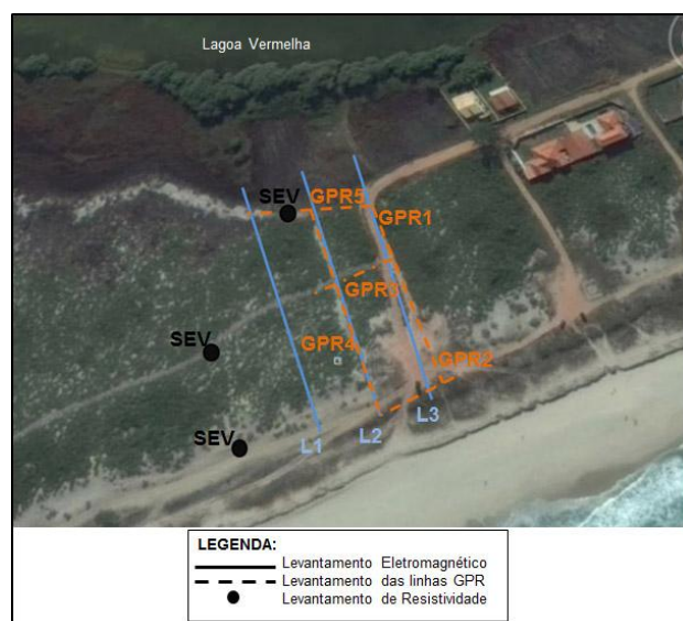
Figura 1 - Croqui dos levantamentos eletromagnético, de resistividade e GPR realizados em Araruama, RJ (modificado de Google Earth).
