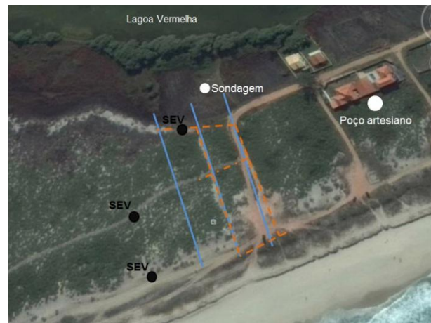
Figura 9 - Localização das sondagens elétricas verticais SEV. Os círculos fechados brancos mostram a sondagem com profundidade de 0,25 m até a lâmina d'água e o poço artesiano de 1,8 m até a água salgada (modificado de Google Earth).
