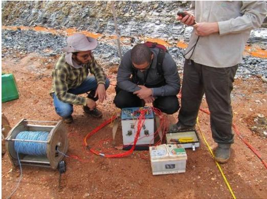
Figura 7 – Aquisição de dados de IP com Syscal Pro 72.
