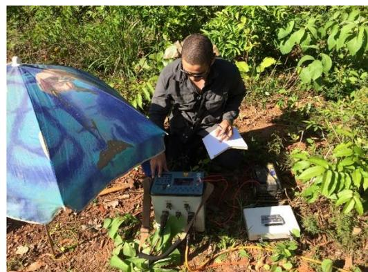
Figura 5 - Aquisição de dados de RES com tempos de injeção de corrente distintos para elaboração dos produtos PFE e MF.
