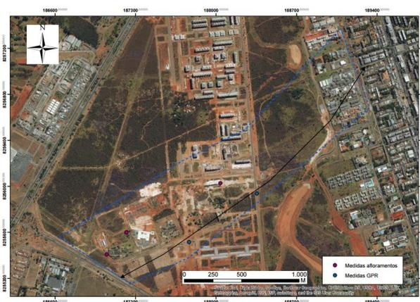
**Figura 9** – Imagem aérea com delimitação do quartzito no Setor Noroeste, com eixo do dobramento e locais que foram obtidas medidas aferidas em afloramentos e por dados GPR.
