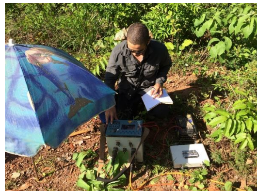
Figura 5 – Fotografia evidencia a aquisição de dados de RES com tempos de injeção de corrente distintos para elaboração das seções de PFE e de MF.
