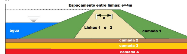
Figura 5 – Modelo de barragem de terra zonada com núcleo de material com menor coeficiente de permeabilidade relativo.
