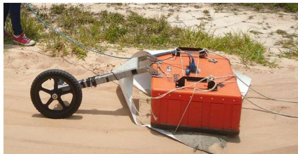
Figura 4 - Antena de 200 MHz e roda conectadas. (Foto: Israeli Rodrigo)
