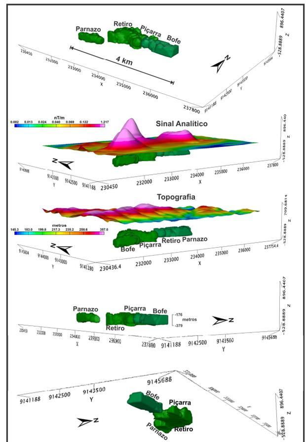
Figura 6 - Modelagem Euler 3D de anomalias magnéticas associadas com intrusões de rochas máficas-ultramáficas mineralizadas em Ni-Cu-PGE.
