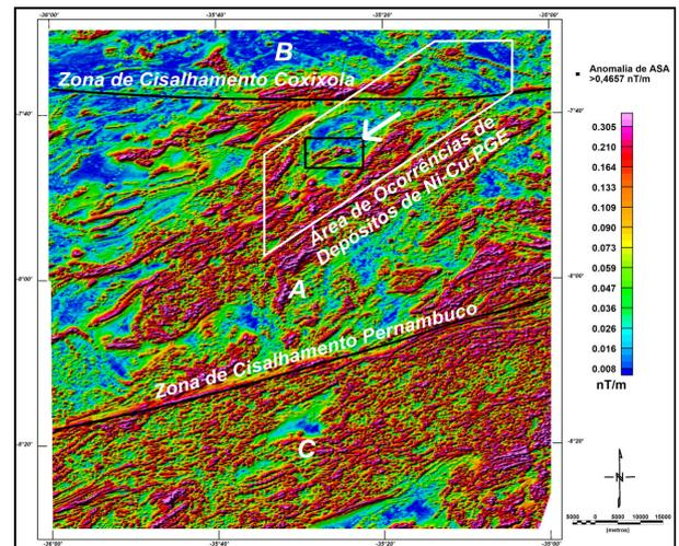
Figura 5 - Amplitude do sinal analítico do campo magnético anômalo com localização das anomalias com gradiente acima de 0,47 nT/m (pontos pretos). A seta branca indica a localização das anomalias magnéticas modeladas por Euler 3D cujos resultados estão apresentados na Figura 6.
