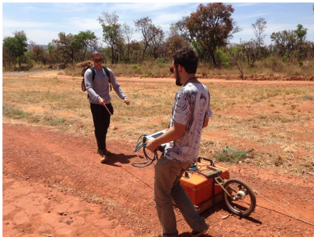
Figura 3 – Foto evidenciando a aquisição de dados de GPR com a antena blindada de 200MHz, na área do Setor Noroeste de Brasília.
