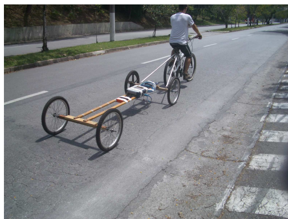
Foto 3 – Aquisição de dados de radar com antena de 2.6 GHz montada sobre carrinho rebocado por bicicleta.
