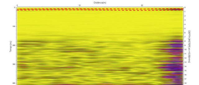
Figura 8. Perfil 23 com uma janela de tempo de 450 ns e antena de 200 MHz.
