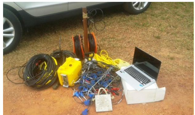
Figura 6- Foto do equipamento utilizado na aquisição sísmica de refração rasa.
