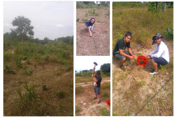
Figura 5- Foto da linha do levantamento de sísmica de Refração rasa no local de estudo.
