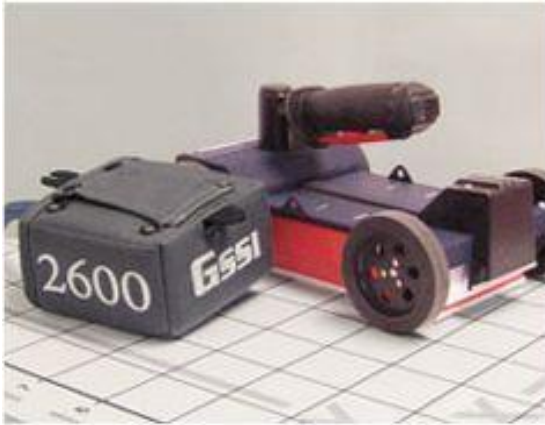
Figura 2 – Modelo do equipamento da GSSI 2,6 GHz utilizado para aquisição de dados em cima da malha quadriculada
