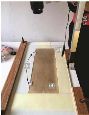
Figura 3: processo de aquisição de imagens de salvaguarda. (1) mesa com vidro antireflexo; (2) suporte para máquina fotográfica; (3) disparador da máquina fotográfica; (4) magnetograma; (5) escala graduada (cm) bidimensional.
