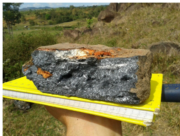
Figura 2 – Foto da amostra do minério de manganês da área de estudo, que evidencia a estrutura de crescimento dos cristais.
