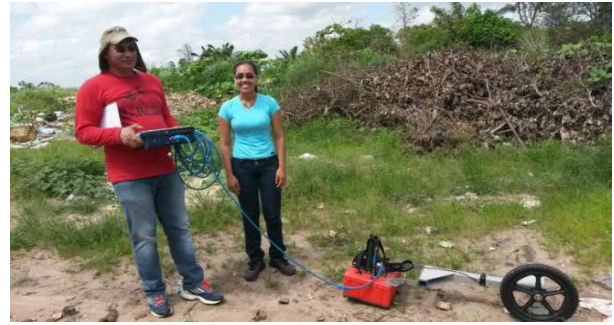
Figura 2. Equipamento GPR utilizado nas coletas dos dados geofísicos com destaque para a vegetação existente nas proximidades do lixão.
