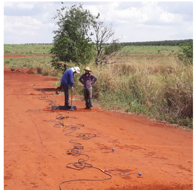
Figura 2. Levantamentos de sismica de refração com onda S na barragem de Cordeirópolis.
