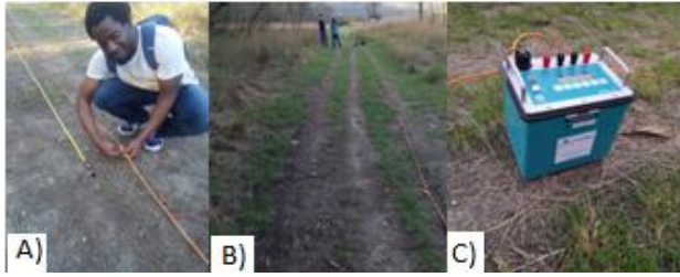
Figura 7 - (A) Cabos dos eletrodos. (B) Perfil de aquisição. (C) Equipamento ERT.
