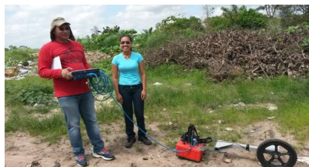
Figura 2. Equipamento GPR utilizado nas coletas dos dados geofísicos com destaque para a vegetação existente nas proximidades do lixão.
