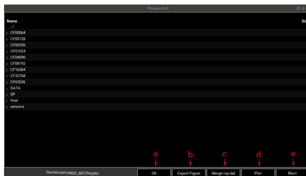
Figura 1 – Tela inicial do programa rhoplusGUI, contendo os Botões: a – Botão de confirmação e seleção do arquivo escolhido para o processamento; b – Botão para exportar a imagem visualizada na tela principal; c – Botão para mesclar e converter os arquivos .rsp; d – Botão para plotar os dados dos arquivos .rsp; e – Botão para executar o Rho +
