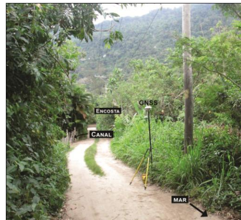
Figura 11: Foto registrada da linha 4, mostrando o equipamento de GNSS Trimble R8s, utilizado para a realização da topografia e da localização de pontos ao deslocar do perfil.
