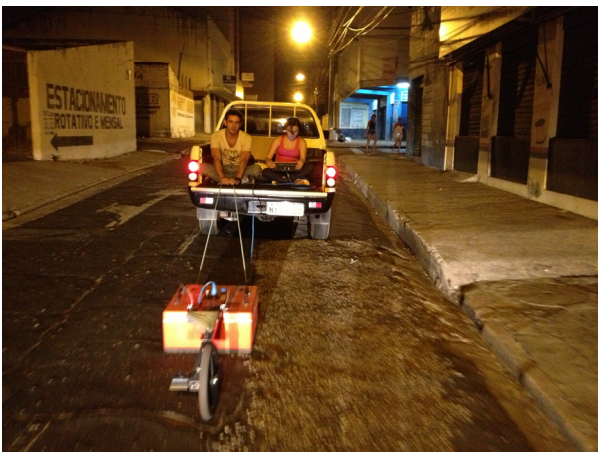
Figura 2 – Fotos evidenciam a aquisição de dados de GPR nas ruas de Teresina, PI.
