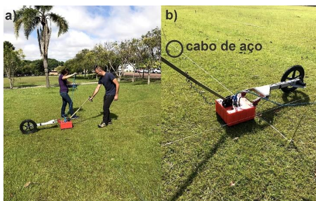
Figura 3 - a) Foto ilustra a aquisição de campo e b) Foto evidencia o cabo de aço utilizado como guia para georreferenciamento dos dados 3D.
