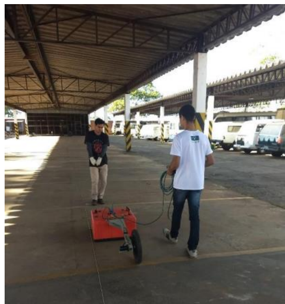
Figura 4. Aquisição de dados de GPR na área da garagem de veículos da UnB.
