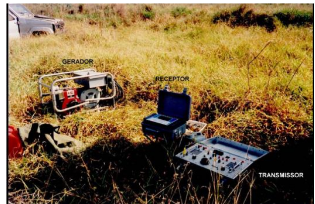
Figura 4: conjunto transmissor TSQ-3 (transmissor + gerador) de 3 KW de potência e IPR-12 digital da Scintrex. Fonte: USP. (2020). Método da polarização induzida – IP
