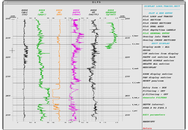
Figura N°2: Perfiles del pozo YPF.Md.B-464: caliper, rayos gamma, potencial espontáneo, resistividad, sísmico y densidad.
