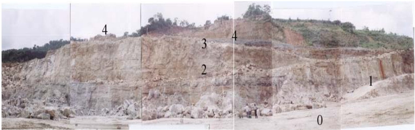
Figura 3-Visão da parede leste da Mina de São Miguel. Cinco níveis de bancada (0 a 4). Folhelhos predominam no nível 4. A medida que se desce na estratigrafia aumenta o conteúdo de carbonatos. Níveis de coquinas são encontrados no nível 1 e abaixo do nível 0.
