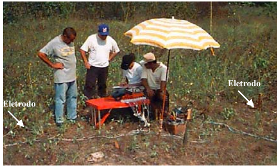
Figura 3 – Operação de medidas de resistividade para obtenção de imagens.
