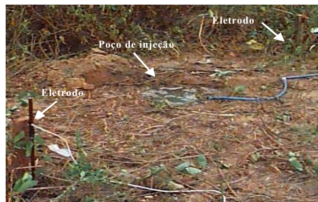
Figura 1 – Poço raso utilizado para a injeção de solução salina.
