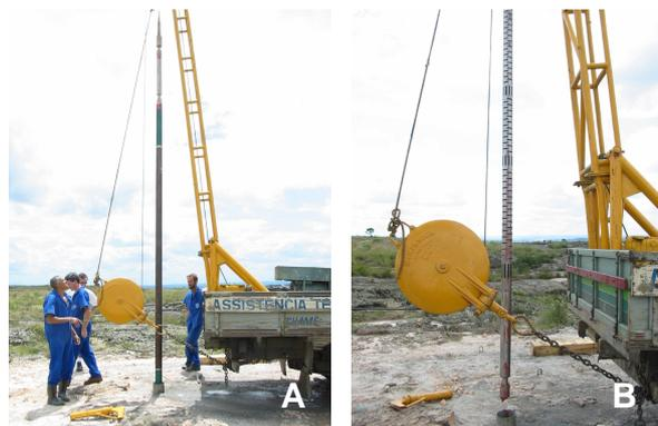
Figura 03 – (A) Ferramenta usada na leitura de perfil elétrico; (B) Ferramenta usada na leitura de perfil sônico.
