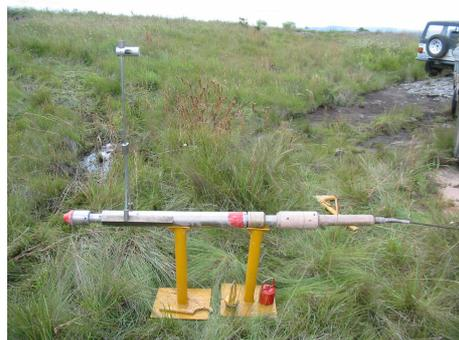
Figura 02 – Ferramenta usada na leitura de raios gama.
