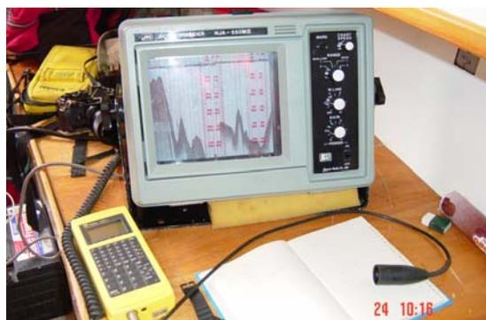
Fig. 4 - Ecobatímetro e Gps em operação.
