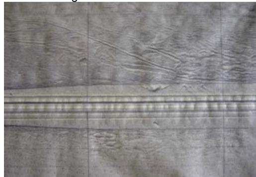
Fig. 6 - registro analógico do sonar de varredura lateral de 100MHz mostrando marcas na superfície de fundo referente ao movimento de icebergs (ice-scours)
