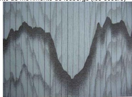
Fig. 7 - registro da eco-sondagem ilustrando a topografia irregular da superfície de fundo da Enseada Martel
