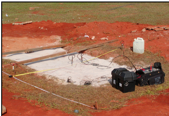
Figura 9 - Aquisição das medidas de resistividade.
