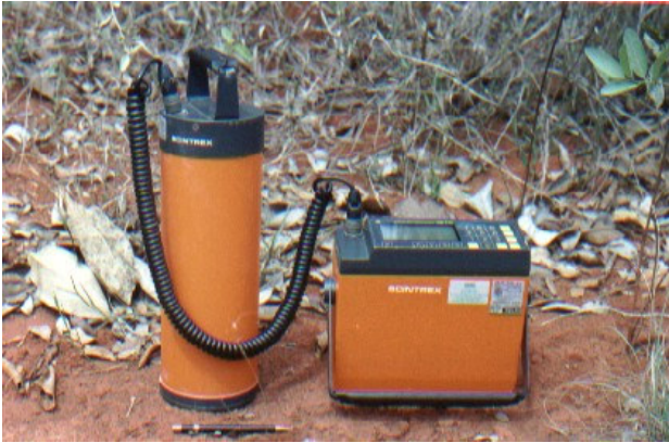
Figura 3 - Gamaespectrômetro GS-512, utilizado durante os trabalhos de campo.
