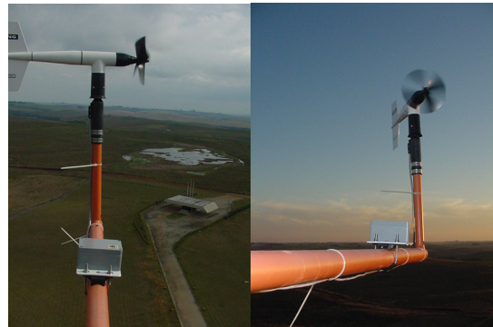
Figura 2 - Anemômetros na torre anemométrica a 50 metros (esquerda) e 25 metros (direita).
