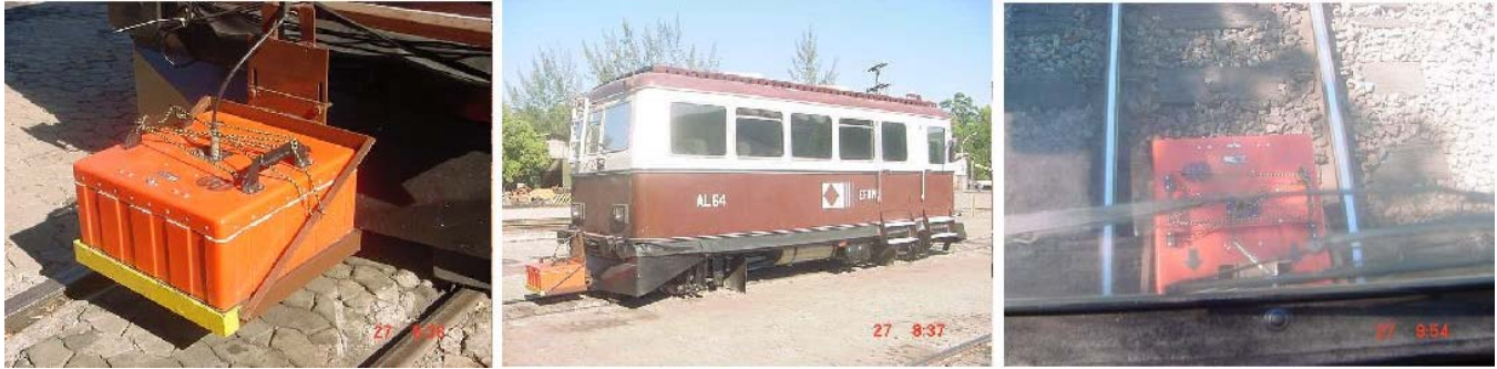
Figura 01 – (a) antena de 200 MHz, (b) carro ferroviário com antena acoplada e (c) vista superior mostrando o posicionamento da antena entre os trilhos e acima do lastro e dormentes.
