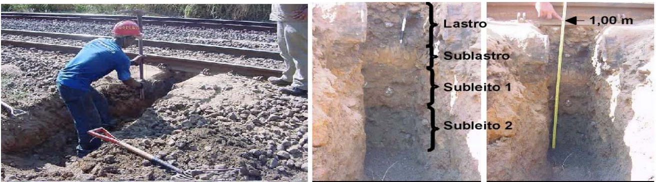
Figura 04 – (a) Escavação transversal no km 212 + 950 m; (b) perfil vertical mostrando as camadas constituintes da subestrutura da ferrovia, revelando um lastro e um sub-lastro totalmente impregnado de argila.
