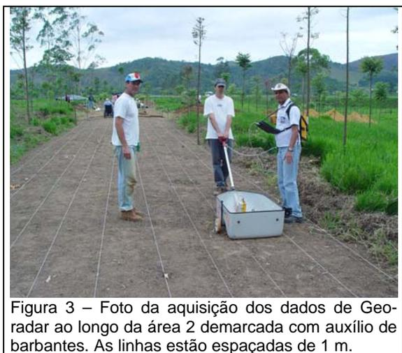
Figura 3 – Foto da aquisição dos dados de Geo-radar ao longo da área 2 demarcada com auxílio de barbantes. As linhas estão espaçadas de 1 m.
