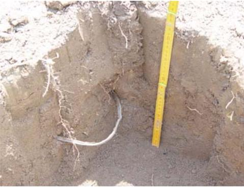
Figura 7 – Foto do cabo de aço enterrado na área – 1, interpretado como anomalia - A5.
