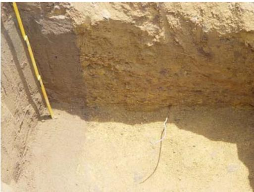
Figura 8 – Foto do cabo de aço enterrado na área – 1, interpretado como anomalia - A6.
