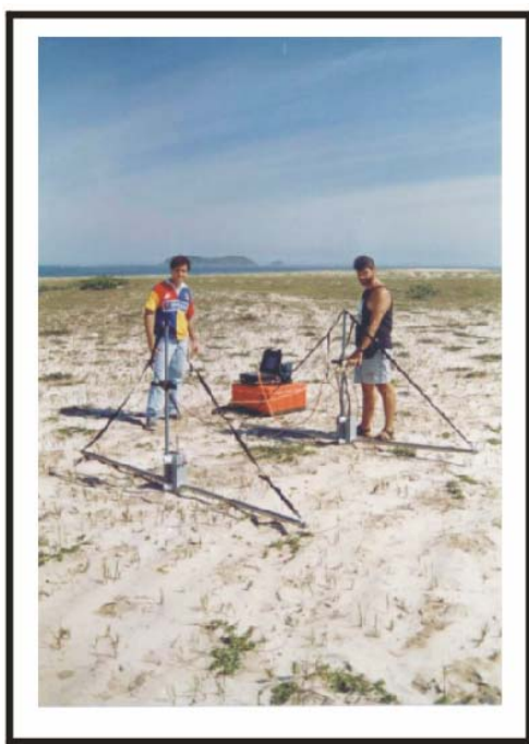
Figura 3- Imagem mostrando aquisição CMP com antenas de 40 MHz para obtenção de velocidades das ondas de radar.
