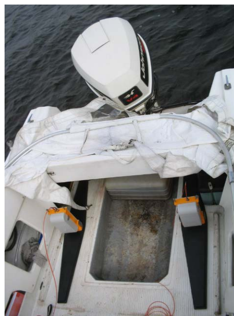
Figura 4 – Antenas GPR de 100 MHz posicionadas no fundo do barco de fibra de vidro.
