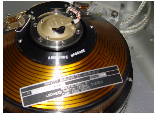
Figura 5: Vista geral do disco do GGI que comporta em seu interior os pares de acelerômetros.
