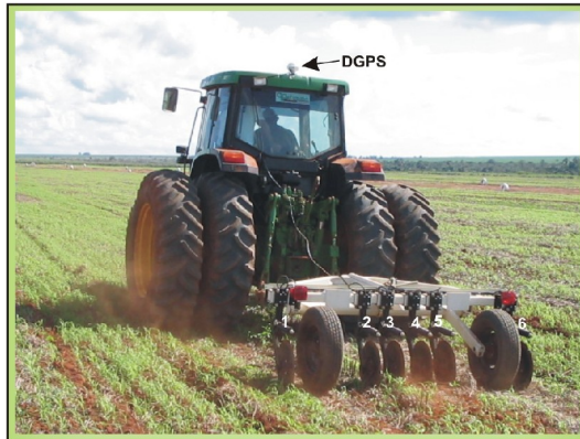
Figura 3. Aquisição de dados de condutividade elétrica contínua com Veris 3100.
