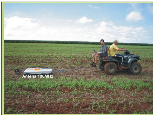
Figura 2. Aquisição GPR com antena blindada de 100 MHz.
