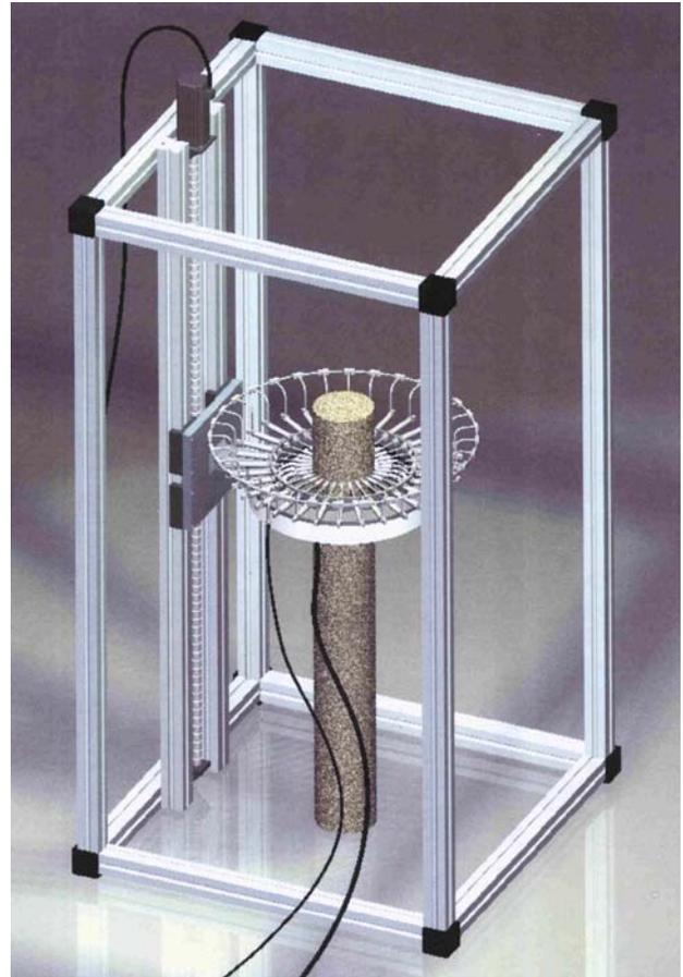
**Figura 6** – Desenho esquemático do tomógrafo ultrassônico projetado.
