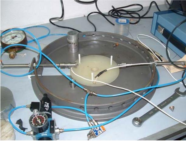
**Figura 4** – Protótipo do tomógrafo ultrassônico, construído para testar alguns itens do equipamento final.
