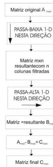
Figura 1 – Modelo esquemático de micronivelamento de Minty, 1991. A escolha da direção do tipo de filtro relaciona-se com as linhas de vôo N-S e linhas de controle E-W.
