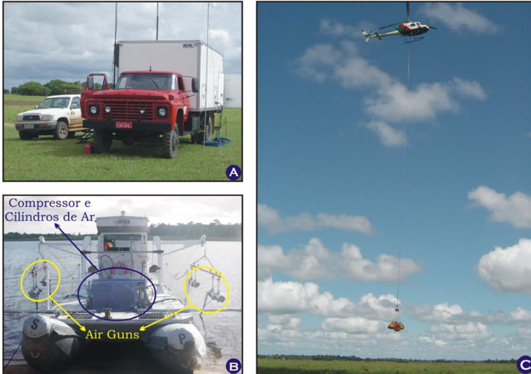
Figura 02 – Equipamentos utilizados no levantamento sísmico realizado no BT-ES-22. **A:** Casa branca montada em caminhão 4x4. **B:** Barco de 32 pés com compressores, cilindros de ar comprimido e arranjo com 04 air guns. **C:** Helicóptero com long line aproximando-se de ponto de apoio para deixar helibags com geofones e caixas para serem revisadas.
