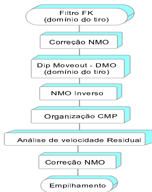
Figura 1: Fluxograma de processamento com a correção DMO no domínio do tiro aplicada na linha sísmica RL-5090 da Bacia do Tacutu.
