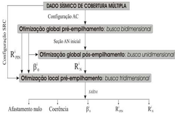
Figura 7: Fluxograma do método de empilhamento SRC. Os atributos SRC - \beta_0 , R_{NIP} e R_N , são, respectivamente, o ângulo de emergência do raio central, o raio de curvatura da onda do ponto de incidência normal e o raio de curvatura da onda normal.
