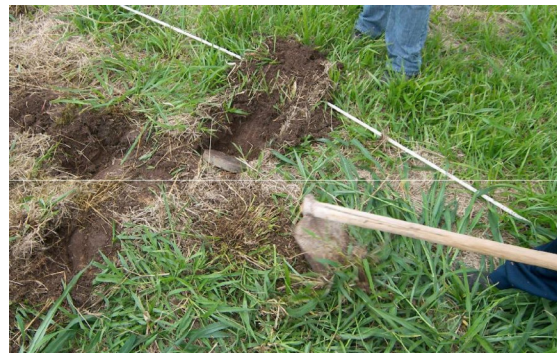
Figura 4 – Ilustração das 4 rampas inclinadas e seus posicionamentos em relação à linha sísmica (em branco).
