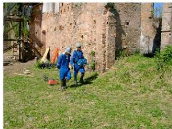
Figura 2 – Fotos das aquisições de dados GPR no Convento São Boaventura, município de Itaboraí/RJ.
