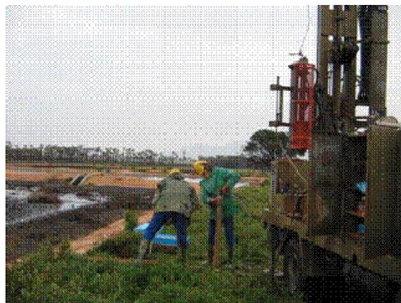
Foto 2. Emplazamiento de la máquina de sondeos, con extracción de testigo.
